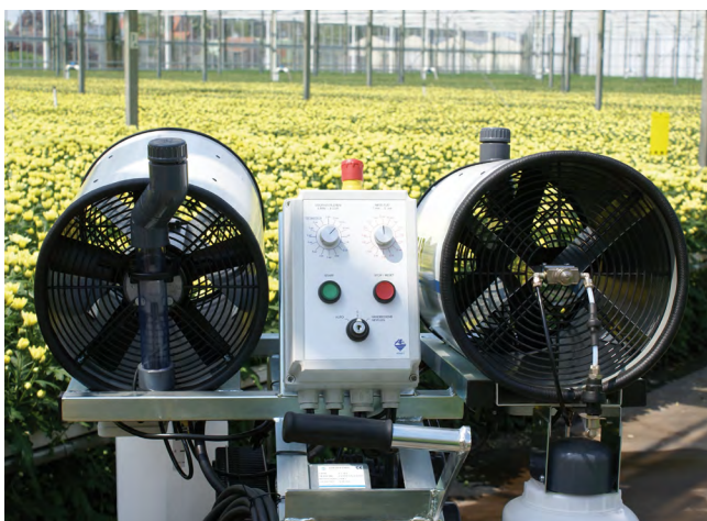
Mobiele opstelling met waterreservoir
